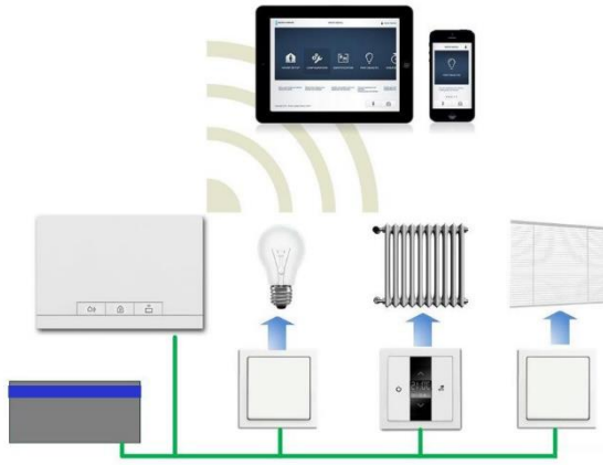
Fig. 35 Instalación de un sistema Free@Home
